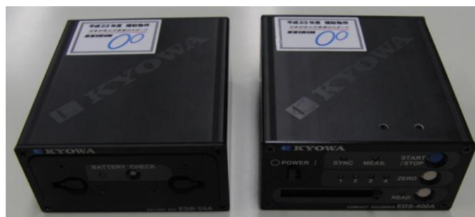
図 2 加速度計測用コンパクトレコーダ（共和電業 EDS-400A）
