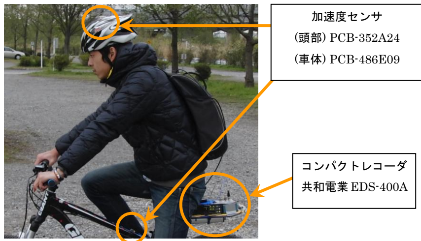
図 3 走行実験における被験者および測定装置
